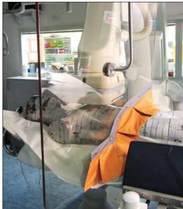
Abb. 1: Schutzzone für femoralen Zugang in der Koronar-Angiographie bestehend aus Blei-Acrylglascheibe mit Lamellenvorhang und Tisch-Seitenschutz, Demonstration am Alderson-Rando-Phantom (Foto Eder)
